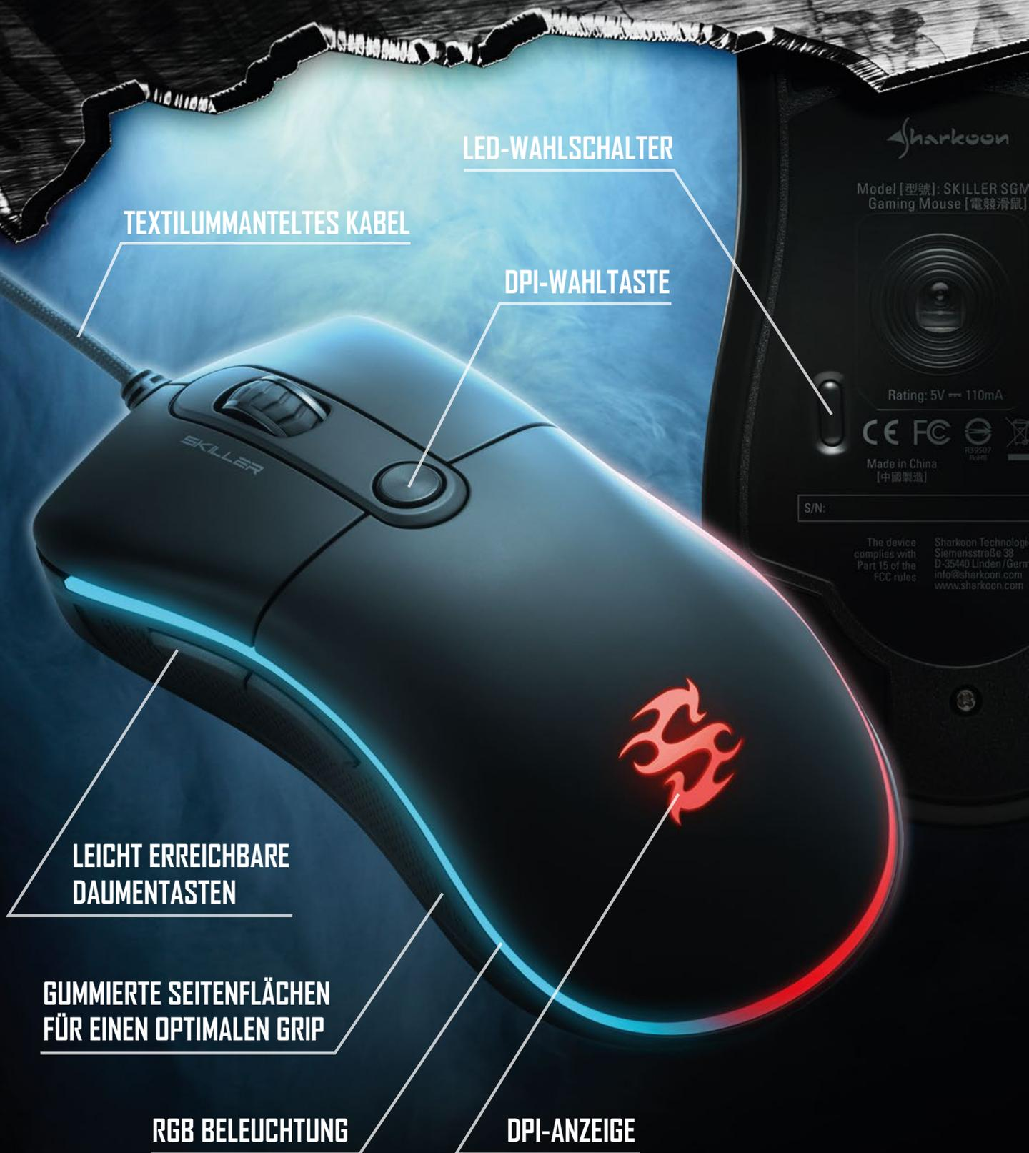
Werden die DPI-Stufen der SKILLER SGM2 gewechselt, ändert sich die Farbe der Beleuchtung für einige Sekunden in Abhängigkeit von der gewählten DPI-Stufe. Die Beleuchtung der SKILLER SGM2 Gaming-Maus lässt sich mittels LED-Wahlschalter an der Unterseite ein- und ausschalten. Außerdem können sechs verschiedene Beleuchtungseffekte ohne Software mit einem Tastendruck durchgeschaltet werden.
